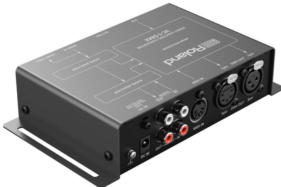
Für die erweiterte Steuerung verfügt der VC-1-DMX über eine integrierte MIDI-zu-DMX-Wandlung. Über MIDI-CC-Befehle eines Hardware-Controllers oder Computers können Anwender diverse DMX-Parameter steuern, darunter globales Dimmen, Tilt, Pan und mehr. Weiterhin lassen sich MIDI Note-Informationen von Keyboards, E-Drums und anderen Instrumenten nutzen, um Lichteffekte auf musikalische Live-Performances abzustimmen.
