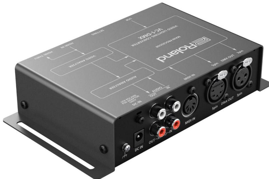
Para mayor control, el VC-1-DMX ofrece conversión de MIDI a DMX integrada. Se pueden usar mensajes de cambio de control MIDI de un controlador físico u ordenador para ajustar diversos parámetros de DMX, como atenuación global, inclinación, panorámica, etc. También se puede emplear la información de nota MIDI de teclados, baterías electrónicas y otros instrumentos para crear efectos de luces que siguen las actuaciones musicales en vivo.
